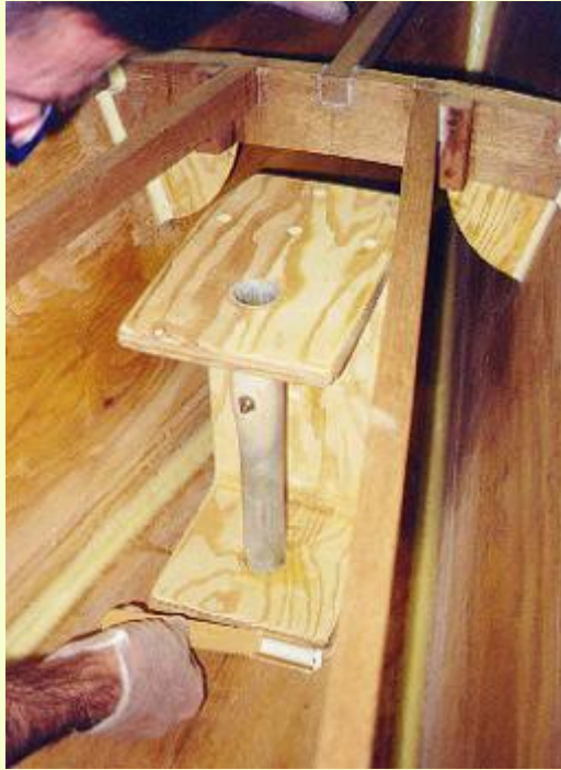
Installing motor mount.
